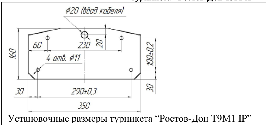
Габаритные размеры турникета "Ростов-Дон Т9М IP"
